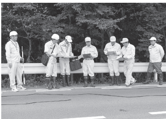
町道4号線のひび割れの調査
