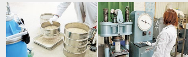
▲粒の大きさを測定する「ふるい分け試験」 ▲コンクリートの強度を検査中
