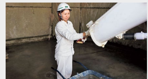
検査する生コンをミキサー車から採取
