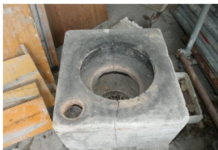
■国見石かまど(昭和初期伊藤氏蔵) 縦70cm×横60cm 高さ100cm 内側にらせん状段差があり火が伝わる。左下の穴は煙突穴
